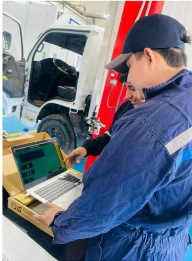
*Fig. 1 Medición con el opacímetro*
