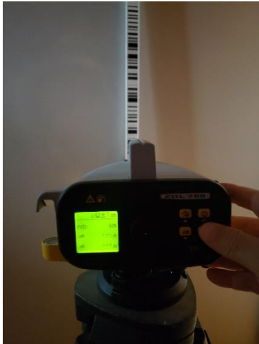
Figura 3.- Mira y Nivel Electrónico
