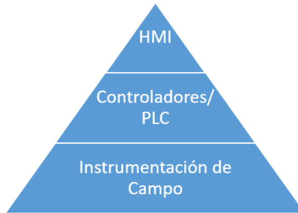
Figura 1: Niveles de composición del sistema SCADA
