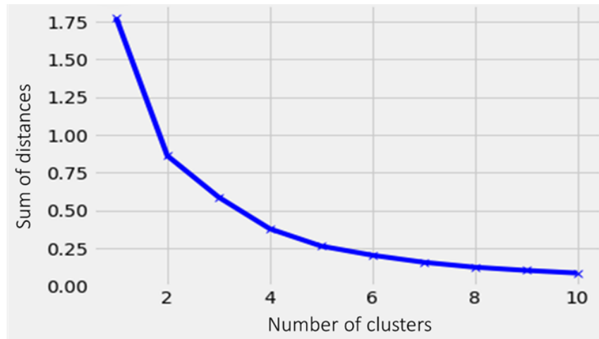
Figura 6: Gráfico del método del codo. El eje x representa el número de grupos y el eje y representa la suma de distancias.
