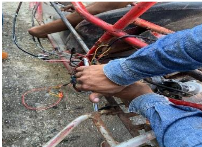
Figura 6. Mantenimiento del sistema eléctrico del buggy
