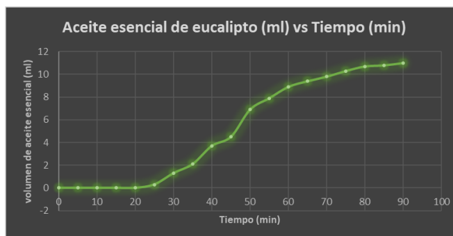
Ilustración 10-3: Curva de extracción de aceite esencial de eucalipto para 2 Kg de materia prima.
