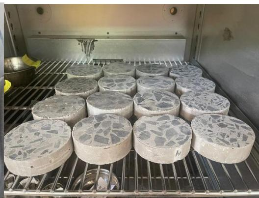
Figura 4. Secado especímenes 50°C.
