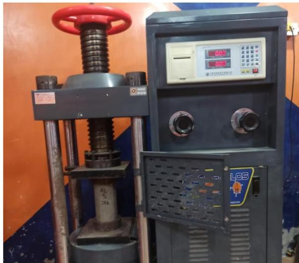
Figura 2. Máquina de compresión.
