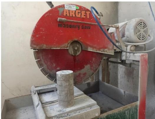
Figura 3. Cortadora de especímenes.
