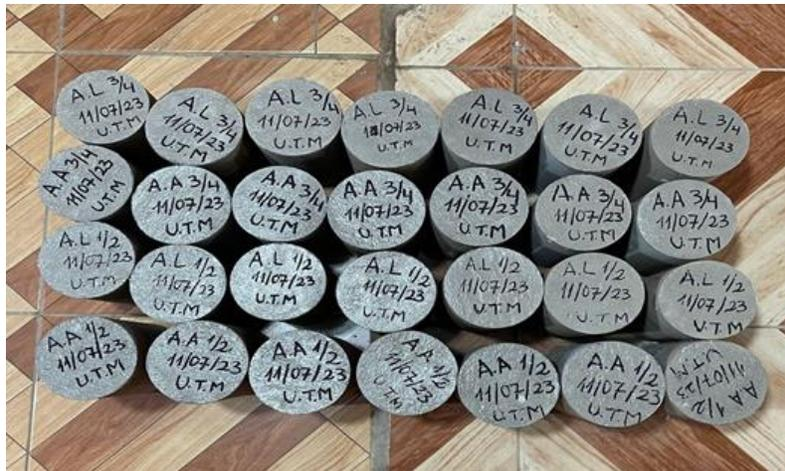
Figura 1. Probetas de hormigón.
