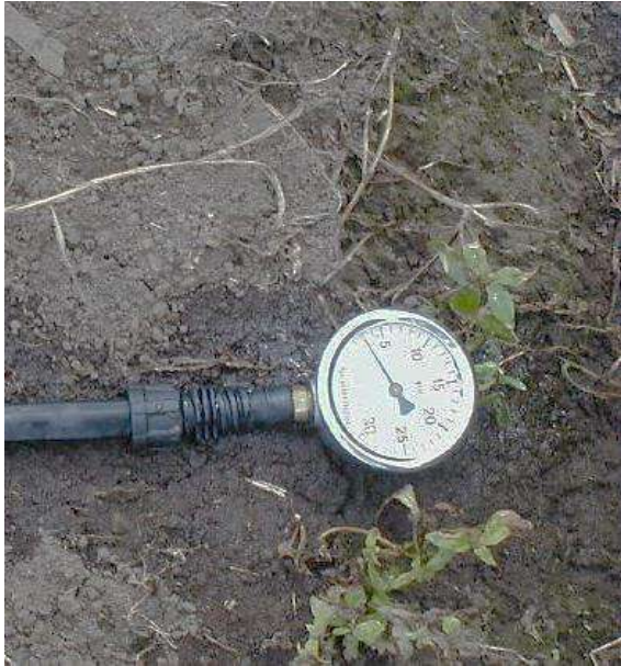
Fig 47. Medición experimental de la presión
