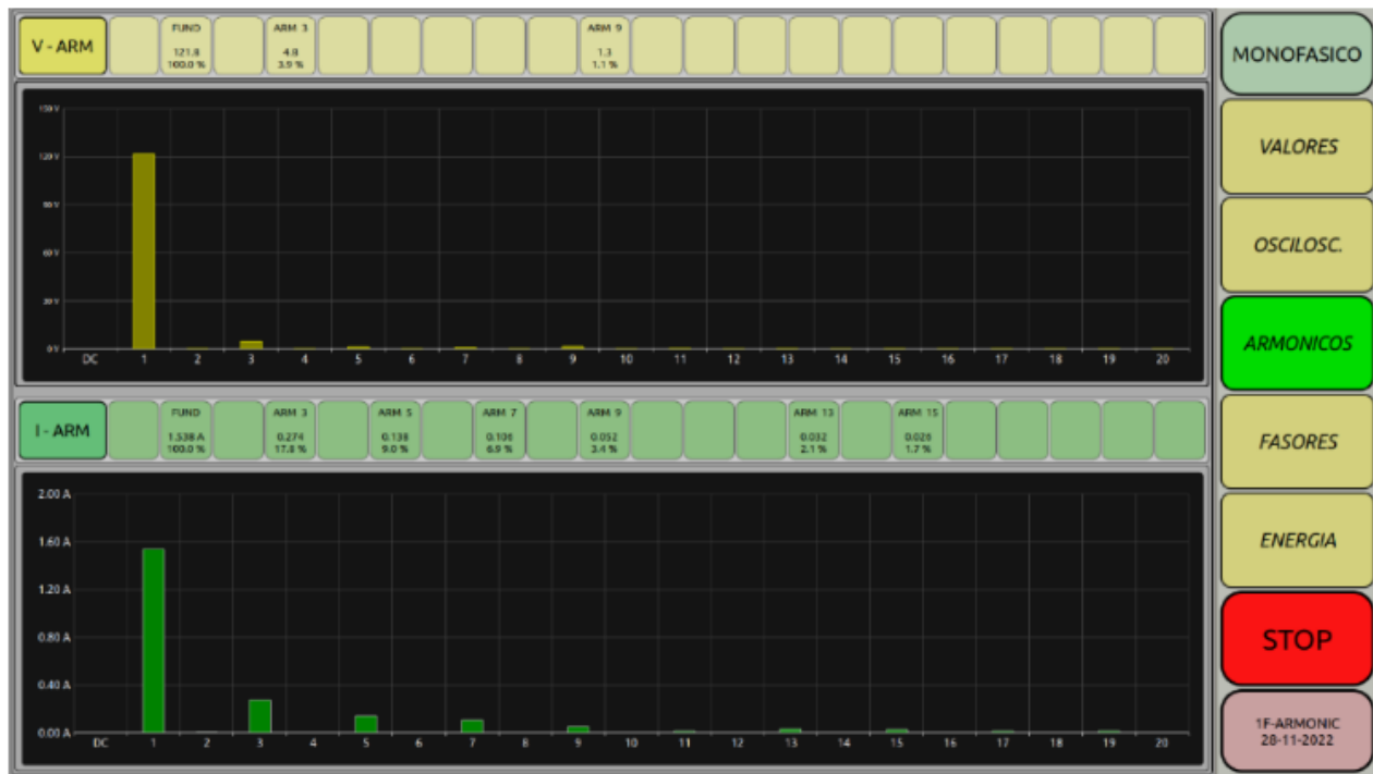
Figura 8. Gráfico de la corriente fundamental y armónicos
