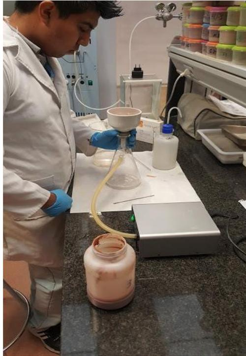
*Imagen: Filtración al vacío*
