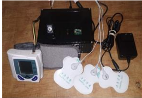
Figura 7: Módulo de telemedicina ensamblado
