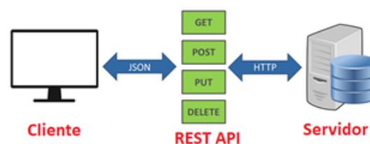
Figura 8: Funcionamiento del servidor
