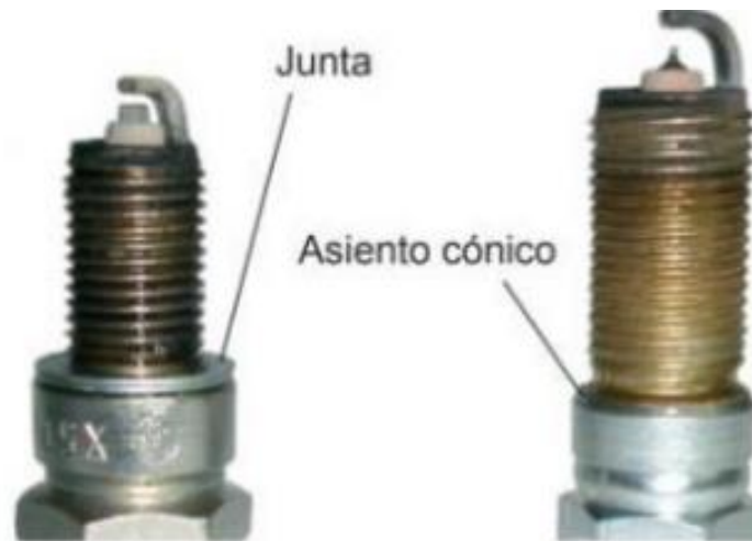
Figura 3: Tipos de bases o roscas de bujías
