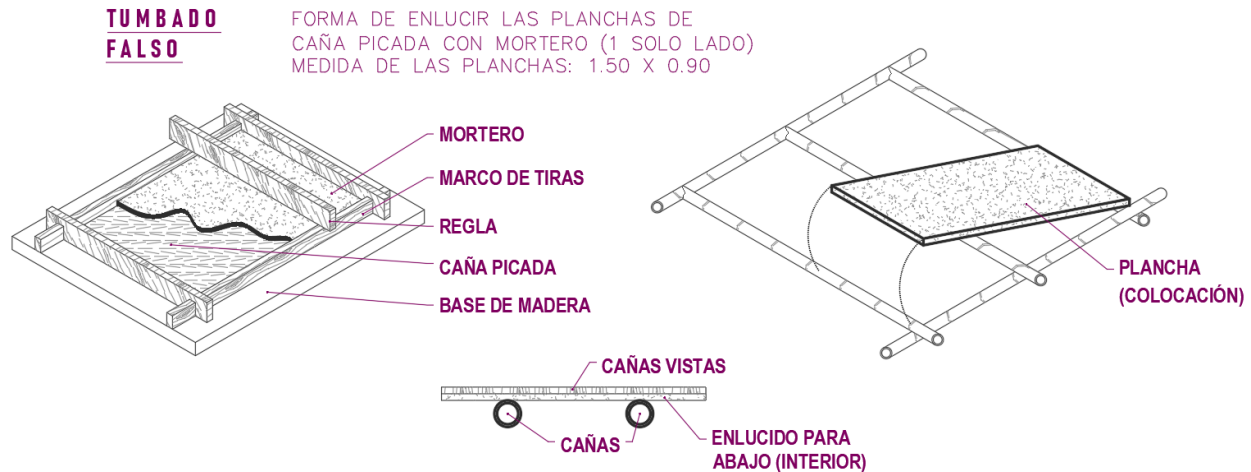
Figura 17. Detalles constructivos para tumbado.
