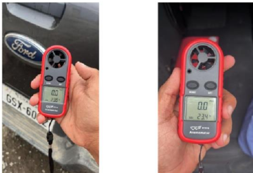
Figura1: muestra el Anemómetro con el cual se realizo la validación de datos.
