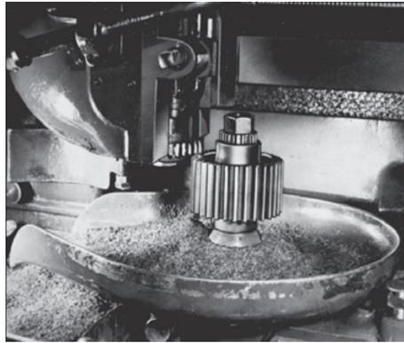
**Fig. 3.** Fabricación de engranajes con piñón-cremallera
