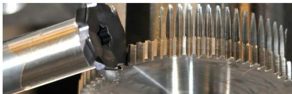
**Fig. 2.** Fabricación de engranajes mediante fresadora
