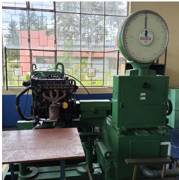
Figura 9. Motor montado en el dinamómetro.
