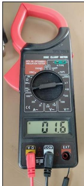
**Figura 12.** Resistencia de Armadura medida con un multímetro.
