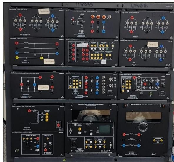
Figura 7. Lab-Volt con sus diferentes módulos de pruebas.
