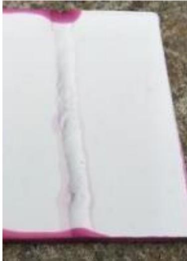
**Figura 4.** Resultado del Ensayo de tintas penetrantes
