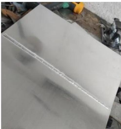
**Figura 3.** Junta de aluminio soldada
