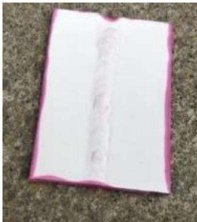
**Figura 5.** Resultado del Ensayo de tintas penetrantes
