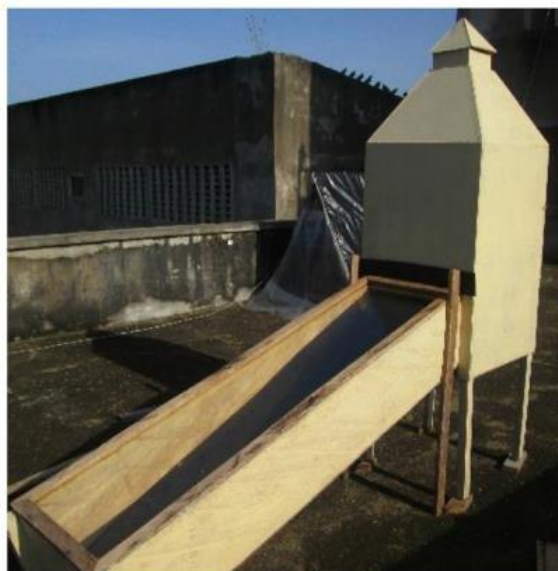
Fig. 20. Deshidratador solar inclinado de un ala en campo Fuente: Knezevic, 2010
