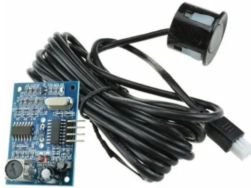
Figura 5 Aspecto físico del sensor ultrasónico sumergible (Mercado libre, 2022)
