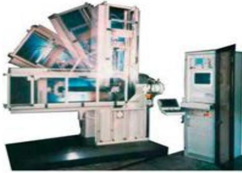
**Figura 10:** Banco de ensayo de amortiguadores Series de IST®.
