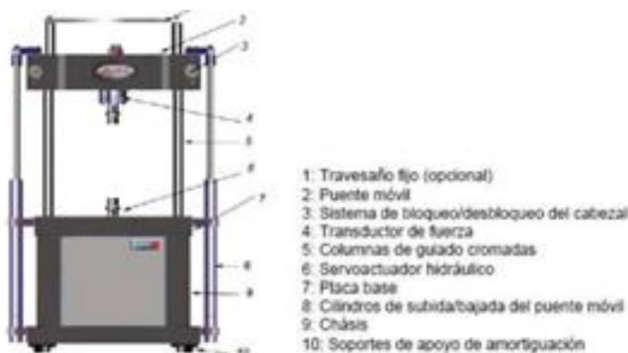
**Figura 9:** Banco de prueba servo-hidráulico
