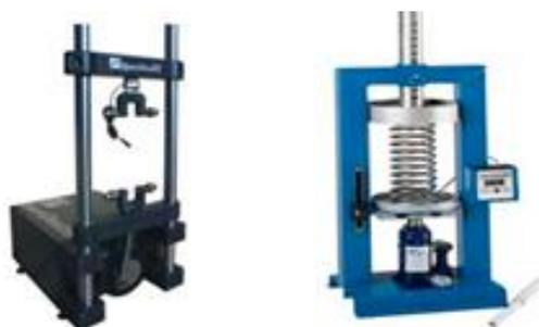
**Figura 12:** Bancos de pruebas de elementos de suspensión
