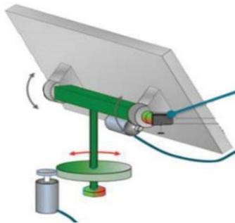
**Figura** ¡Error! No hay texto con el estilo especificado en el documento.-7 Ensamblaje mecánico de un seguidor solar
