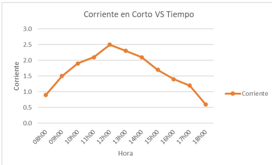
Figura 31 Gráfico de Corriente VS Tiempo de panel solar móvil
