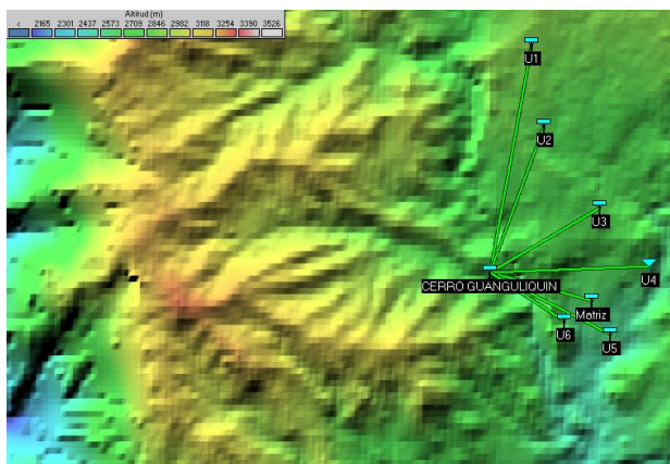
Figura 10: Enlaces entre de estación base, usuarios y backhaul.
