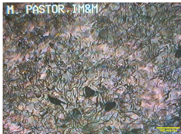
Ilustración 5. Micrografía de hierro fundido con matriz perlítica y hojuelas de grafito (lo negro) nital 2% (111X).
