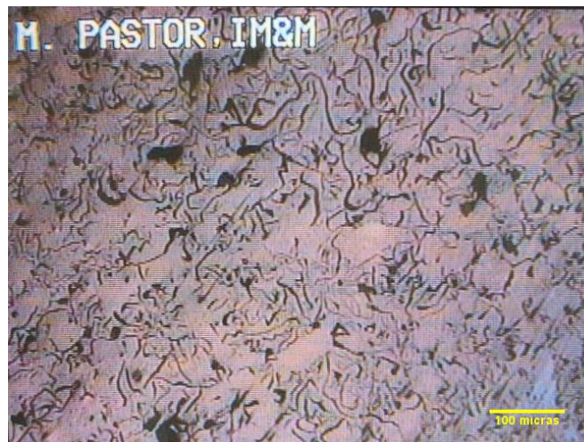
Ilustración 7. Micrografía de hierro fundido sin ataque (111X)
