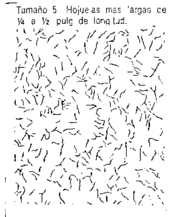
Ilustración 9. Microestructura de hierro fundido Tamaño 5 (hojuelas de grafito lo negro) (Introducción a la Metalurgia Física AVNER)
