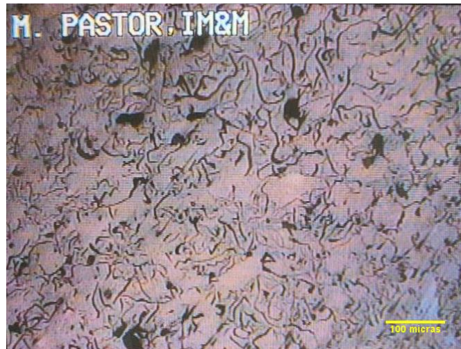
Ilustración 8. Micrografía hierro fundido, lo negro hojuelas de grafito sin ataque (111X)
