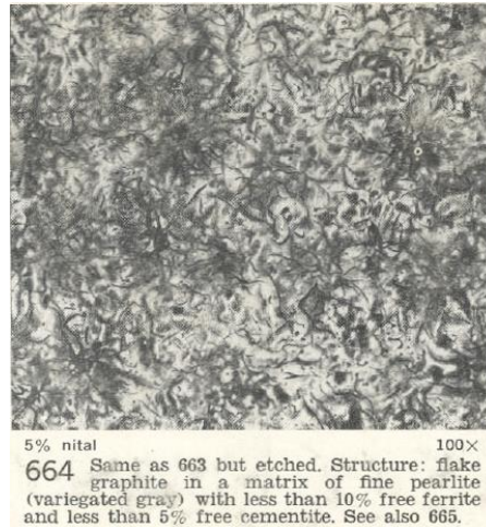
Ilustración 4. Hierro fundido con presencia de grafito en escamas en una matriz perlítica fina (gris abigarrado) con menos del 10% de ferrita libre y menos 5% de cementita libre nital 5% (100X) (Metal Handbook Cast Irons).
