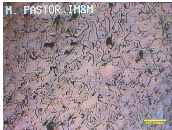
Ilustración 10 Microestructura de hierro fundido, lo negro hojuelas de grafito sin ataque (111X)
