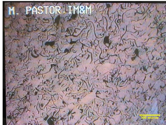
Ilustración 2 Microestructura hierro fundido tomada en el laboratorio lo negro grafito sin ataque (111X).
