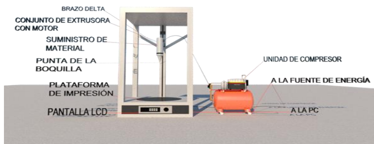
Figura 1. Diagrama esquemático de una impresora 3D por extracción
