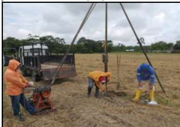
Figura 1: Ensayo de Penetración Estándar (SPT) en los suelos de la ciudad de Calceta.
