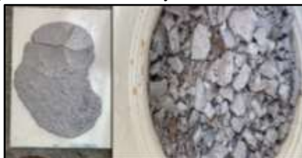
Figura 4: Solidificación y Triturado del PET
