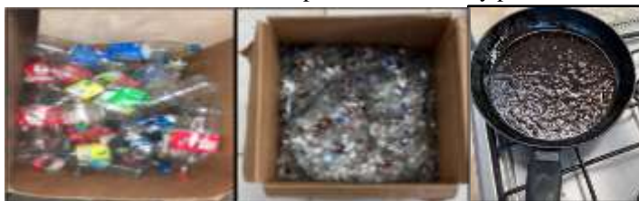
Figura 3: Recolección de botellas de plástico, triturado y proceso de fundición
