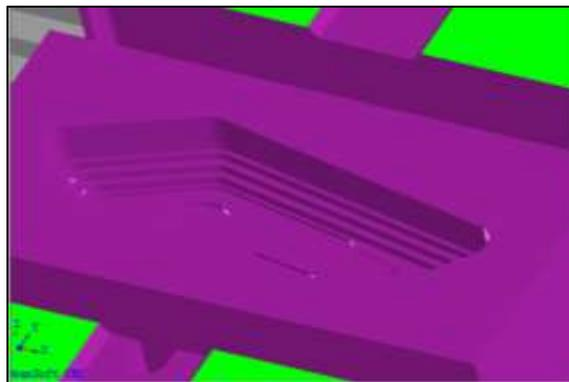
**Figura 10:** Molde obtenido mediante la simulación virtual del Mecanizado en SwanSoft (Macho).
