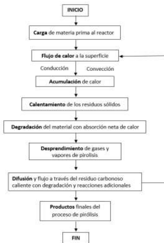
Figura 1: Proceso de pirolisis
