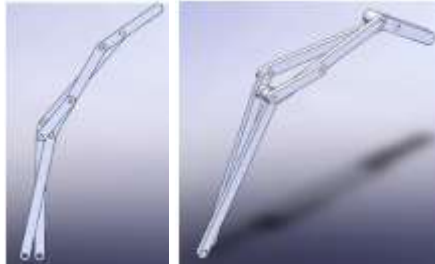
Figura 13: Modelo sólido de un mecanismo de dedo mecánico.
