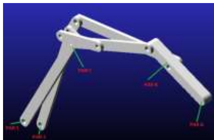
Figura 14: Modelo sólido de un mecanismo de dedo mecánico en MSC ADAMS.
