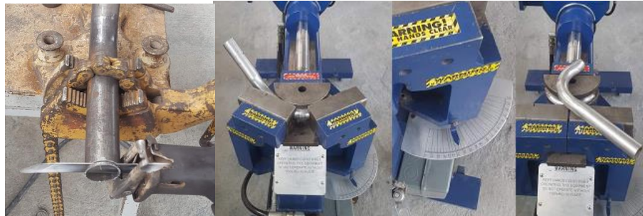
Figura 3: Corte y doblaje de tubería según su longitud
