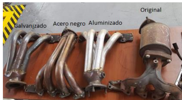
Figura 4: Múltiple de escape original y 3 header's con materiales alternos
