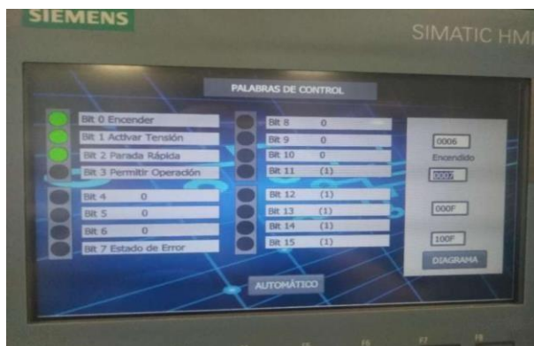
Figura 5-3: Visualización de la segunda palabra de estado “ENCENDIDO”.
