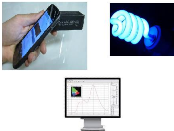
Figura 1: Esquema utilizado para la adquisición de los espectros de luz
