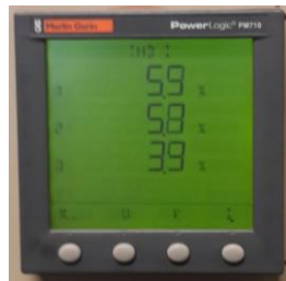
Figura 28: THDi del sistema después de compensar el tercer armónico
