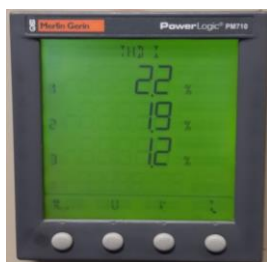
Figura 30: THDi del sistema después de compensar todos los armónicos
