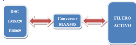
Figura 18: Diagrama de Bloques de la comunicación entre el DSC y el Filtro Activo Shaffner Ecosine Active
