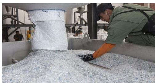
Figura 1 Resina PET-PCR de Enkador se destina a la producción de hilo ecológico
