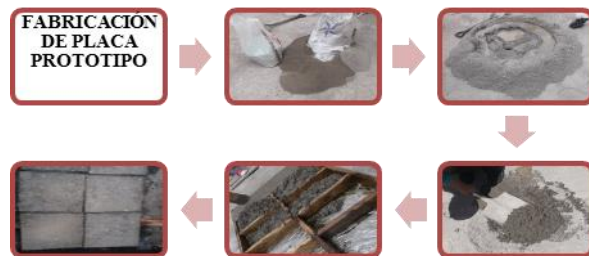
Figura 5 Proceso de elaboración de la placa prototipo Realizado por: Morales Carolina, Pérez Beatriz. 2017
